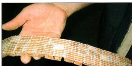
Die Unterseite der Steine wird beim Terrazzoboden zur Sichtseite, wobei das Gitter abgelöst und die Steine geschliffen werden.
